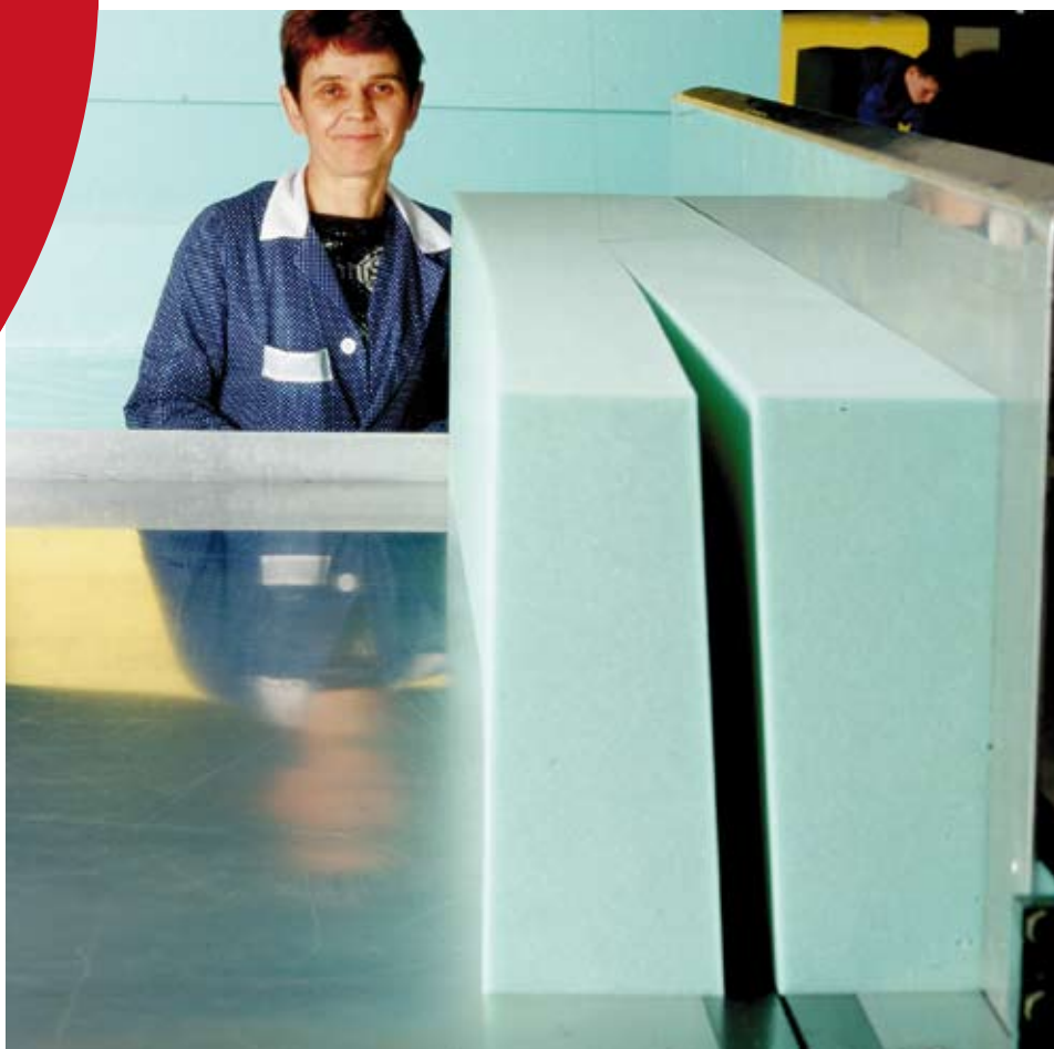
Cięcie pianki na maszynie pionowej. FOT. EUROFOAM
