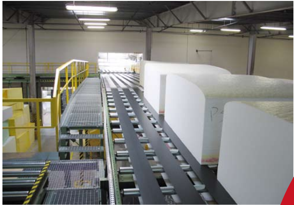
Transport gotowych bloków do magazynu. FOT. EUROFOAM
